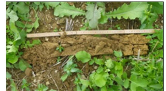
Sondage 230 : traces d'hydromorphie au-delà de 0,25 m, sans gley au-delà de 0,80 m (zone non humide).
