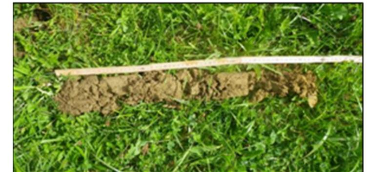
Sondage 27 : traces d'hydromorphie au-delà de 0,25 m, sans gley au-delà de 0,80 m (zone non humide). (zone humide).
