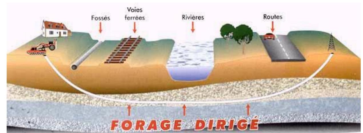
Figure 5 : Illustration d'un forage dirigé
